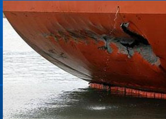
NUMA SEGUNDA FASE DEVE ESGOTAR-SE A ÁGUA. DE SEGUIDA, DESLOCAR TODOS OS PESOS PARA O BORDO CONTRÁRIO AO ROMBO, NAVEGANDO COM O BORDO DO ROMBO SE POSSÍVEL A SOTAVENTO / SOTACORRENTE, RUMANDO O MAIS RAPIDAMENTE POSSÍVEL PARA TERRA.
